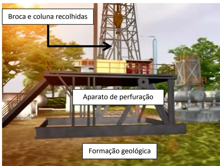
Figura 1. Esquema de um sistema de perfuração (perfuratriz). Fonte: acervo pessoal do autor, adaptado de Halliburton INC.
