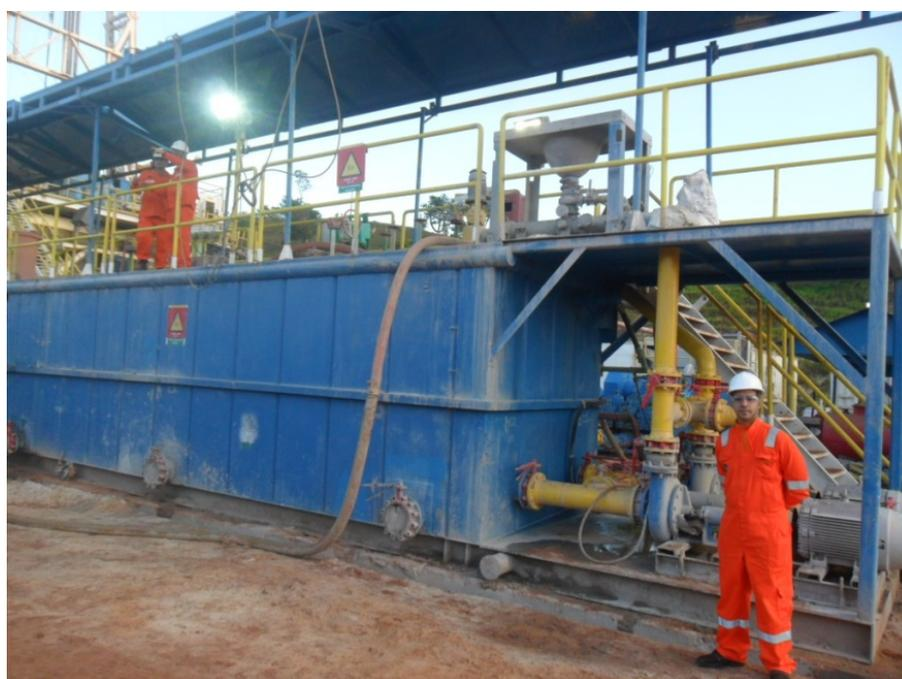
Figura 12. Tanque de produção e armazenamento de fluido de perfuração. Fonte: Acervo pessoal do autor.
