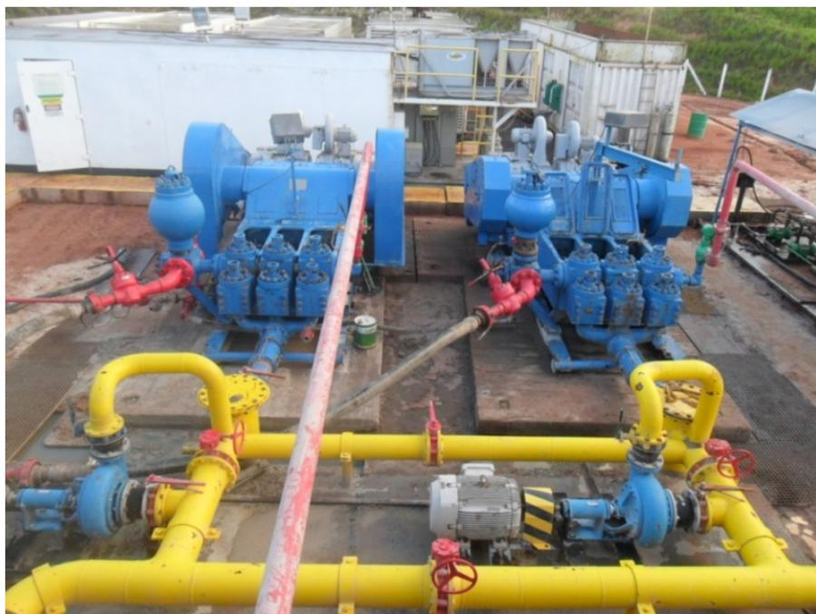
Figura 10. Bombas especiais que admitem os fluidos de perfuração para dentro do sistema coluna/broca. Fonte: Acervo pessoal do autor.
